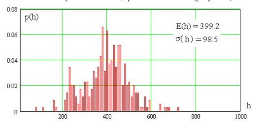
Рис. 3. Распределение расстояний Хэмминга по модулю 256 для пароля на русском языке «Мишка косолапый», длина проверочного текста на русском 316 знаков
