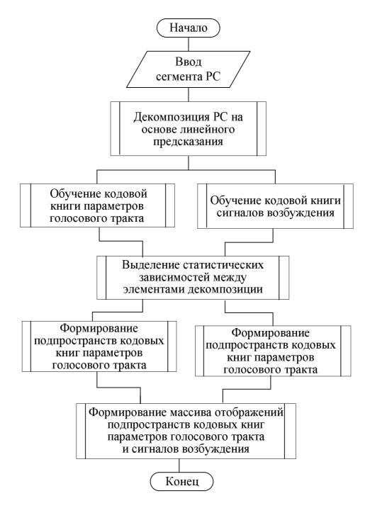
Рис.1. Блок-схема алгоритма нахождения взаимозависимостей элементов декомпозиции речевого сигнала при линейном предсказании
