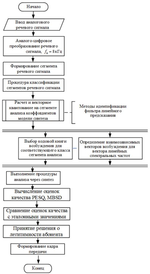
Рис.2. Обобщенная блок-схема функционирования системы обработки речевого сигнала на передающей стороне
