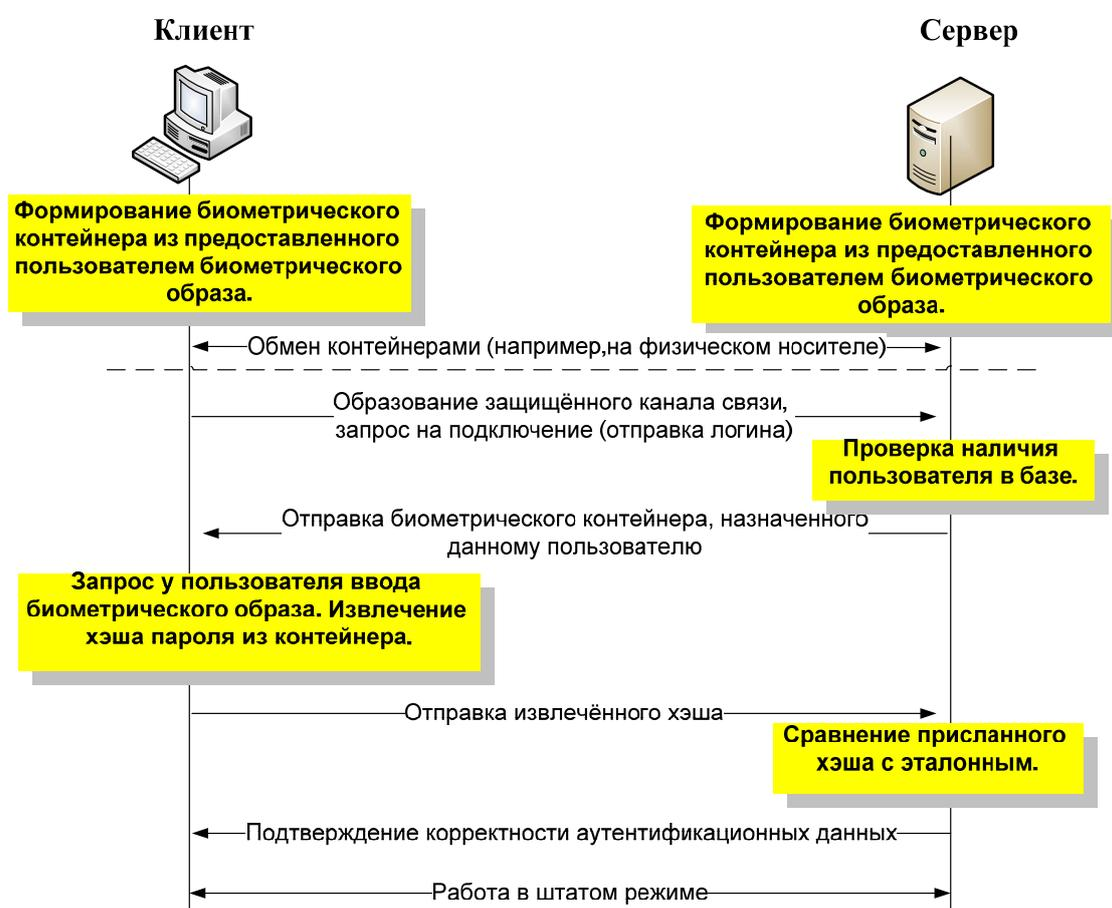
Рис.2 Схема клиент-серверного взаимодействия системы при подключении нового клиента (проверка клиента сервером)
